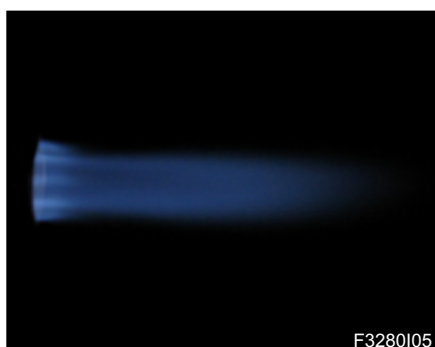
Exceso de aire
