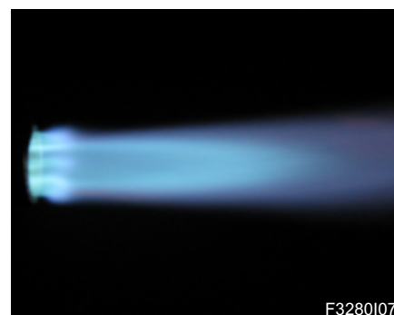
Exceso de gas
