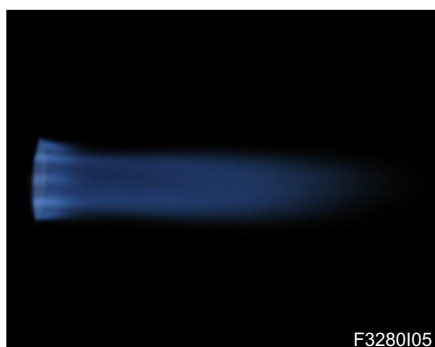
Exceso de aire
