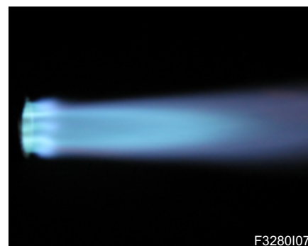
Exceso de gas
